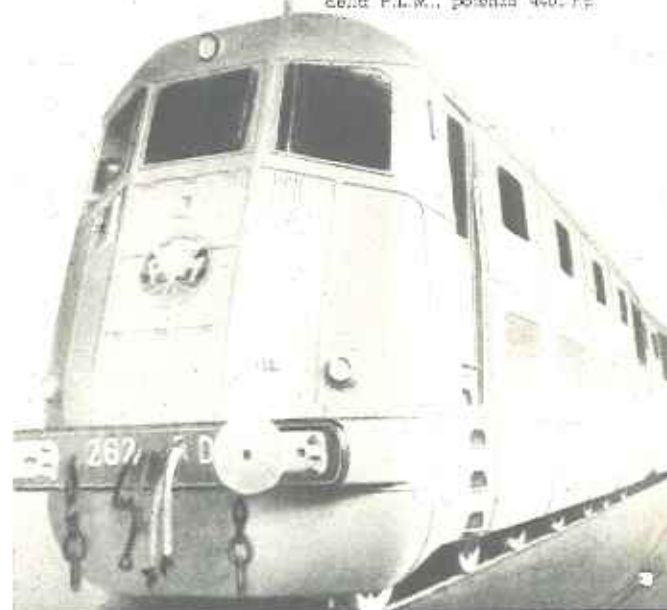
Locomotiva con motore Diesel-Sulzer e trasmissione elettrica della P.L.M., potenza 4400 hp
